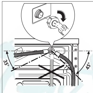
3. Отрегулируйте положение шланга, ослабив зажимную гайку. Отрегулировав положение шланга, не забудьте плотно затянуть зажимную гайку для предотвращения утечек.
