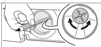
11. Установите фильтр на место, аккуратно вставив его по направляющим. Плотно закрутите крышку насоса, вращая ее по часовой стрелке.
