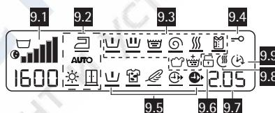
**9.1** - Индикатор скорости отжима, символы функций "ОСТАНОВКА С ВОДОЙ В БАКЕ" и "НОЧНОЙ ЦИКЛ" .
