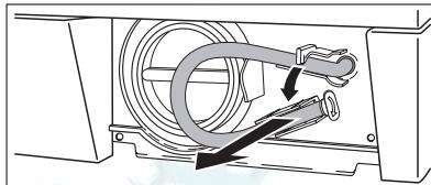
7. Когда вода перестанет литься, отвинтите крышку насоса и извлеките фильтр. При необходимости используйте плоскогубцы. Всегда держите под рукой тряпку, чтобы вытереть воду, которая может пролиться при снятии фильтра.
