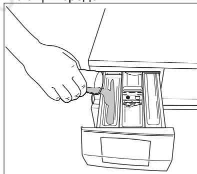
2. . При необходимости насыпьте смягчитель ткани в отделение дозатора, помеченное символом
